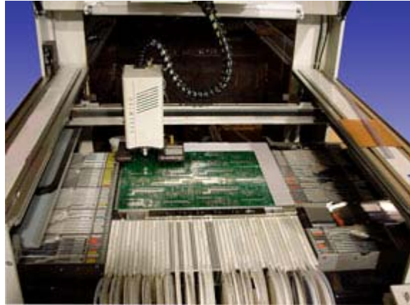
Bild 2: CLM9000: Viel Feederkapazität für Standardbauteile
